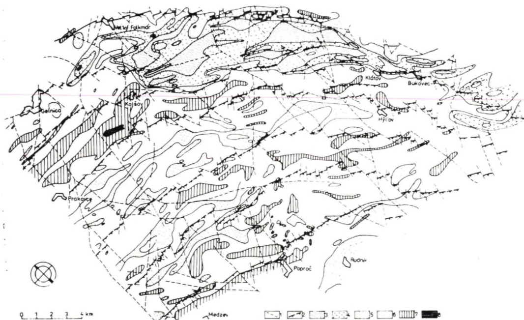
Obr. 6. Mapa úhrnného žiarenia gama [geologická situácia podľa Greculu, 1982]. 1 — zlomy, 2 — hranice príkrovov, 3 — izolínie pod 3 \mu\text{R/h} , 4 — izolínie 3 - 5 \mu\text{R/h} , 5 — izolínie 5 - 7 \mu\text{R/h} , 6 — izolínie 7 - 10 \mu\text{R/h} , 7 — izolínie 10 - 15 \mu\text{R/h} , 8 — izolínie nad 15 \mu\text{R/h}
