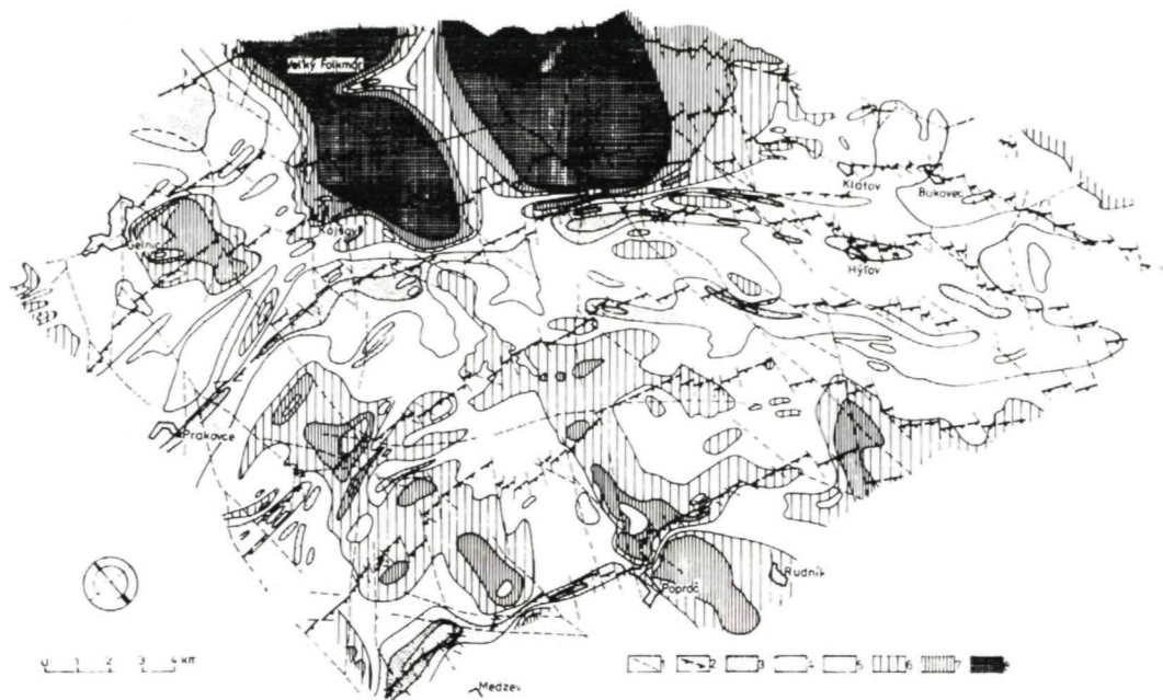
Obr. 5. Mapa spontánnej polarizácie (geologická situácia podľa Greculu, 1982). 1 — zlomy, 2 — hranice príkrovov, 3 — izolínie pod -500 mV, 4 — izolínie od -500 do -100 mV, 5 — izolínie od -100 do 0 mV, 6 — izolínie 0 - 50 mV, 7 — izolínie 50 - 100 mV, 8 — izolínie nad 100 mV
