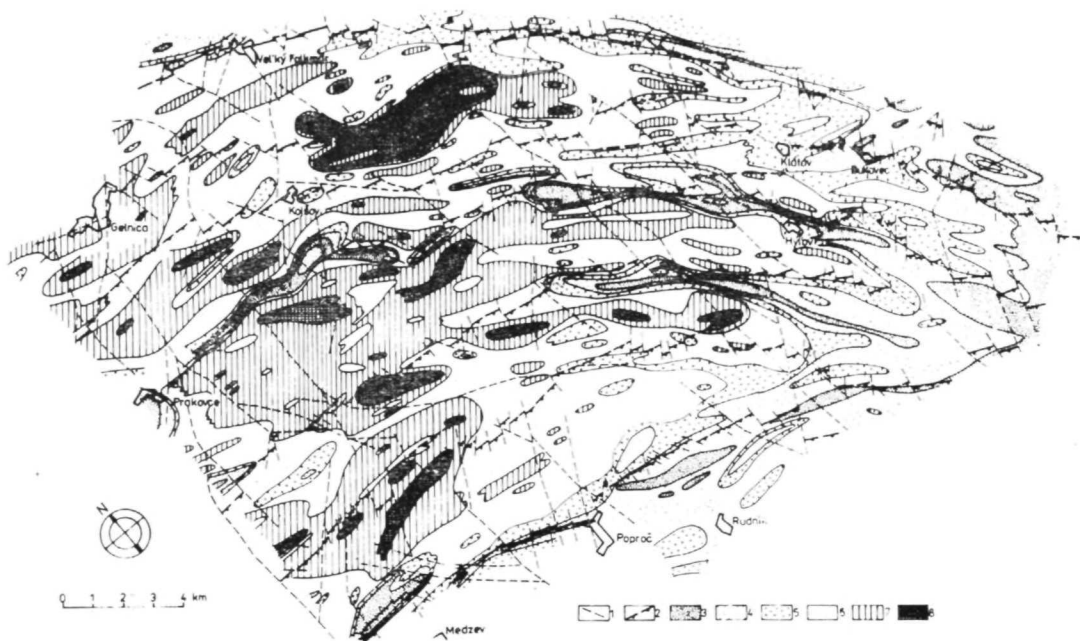
Obr. 4. Mapa elektrického odporu (geologická situácia podľa Greculu, 1982). 1 — zlomy, 2 — hranice príkrovov, 3 — izolínie s hodnotou 100 \Omega\text{m} , 4 — izolínie 100 — 300 \Omega\text{m} , 5 — izolínie 300 — 500 \Omega\text{m} , 6 — izolínie 500 — 1000 \Omega\text{m} , 7 — izolínie 1000 — 2000 \Omega\text{m} , 8 — izolínie nad 2000 \Omega\text{m}
