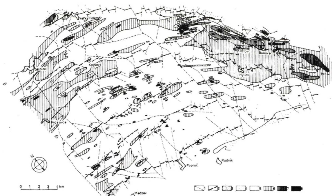
Obr. 1. Mapa magnetického poľa \Delta T (geologické a tektonické prvky podľa Greculu, 1982). 1 — zlomy, 2 — hranice prúvkov, 3 — izolínie s hodnotami pod -50 nT, 4 — izolínie -50 až 0 nT, 5 — izolínie od 0 do 30 nT, 6 — izolínie od 30 nT do 100 nT, 7 — izolínie od 100 do 300 nT, 8 — izolínie nad 300 nT
